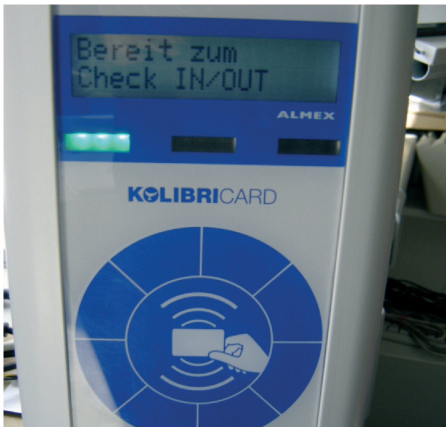
»Check IN/OUT«: Der Fahrpreis wird automatisch vom Hintergrundsystem ermittelt.
